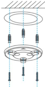
4. Установите камеру на основание и поверните ее на 15°, чтобы зафиксировать.
