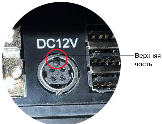
Рисунок 13. Разъём питания POS-терминала.
