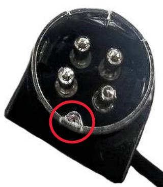
Рисунок 12. Ключ, защищающий от неправильного подключения
