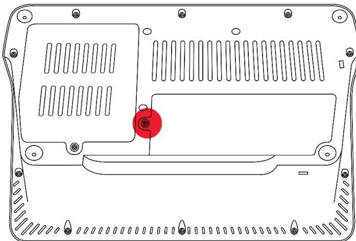
Рисунок 5. Расположение винта крепления крышки интерфейсных портов
