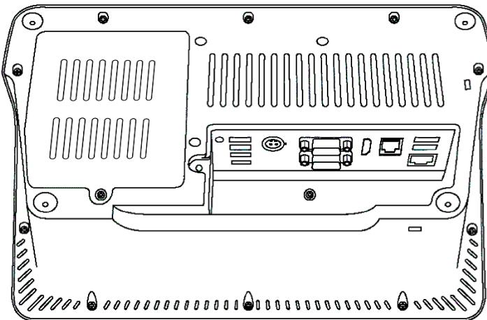
Рисунок 6. Устройство со снятой крышкой интерфейсных портов
