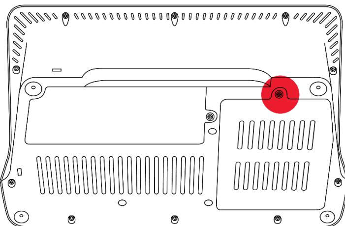
Рисунок 7. Расположение винта крышки отсека для накопителя SSD и оперативной памяти
